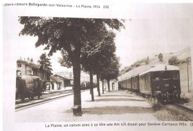
La même année, un convoi avec à sa tête une motrice diesel Am 4/4 en partance pour Cornavin. Il y a un quai central avec une rangée d'arbres du plus bel effet. Sur le même quai, un omnibus La Plaine-Cornavin tracté à la vapeur et un cliché représentant les installations vétustes du poste de commandement de la gare. Puis une rame BDe 4/4 en 1978, avec son pantographe.
